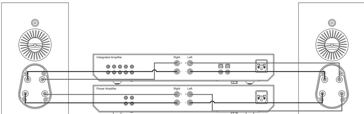
**! HINWEIS: Bei der Verdrahtung nach dieser Methode MÜSSEN die Klemmbrücken entfernt werden.**
