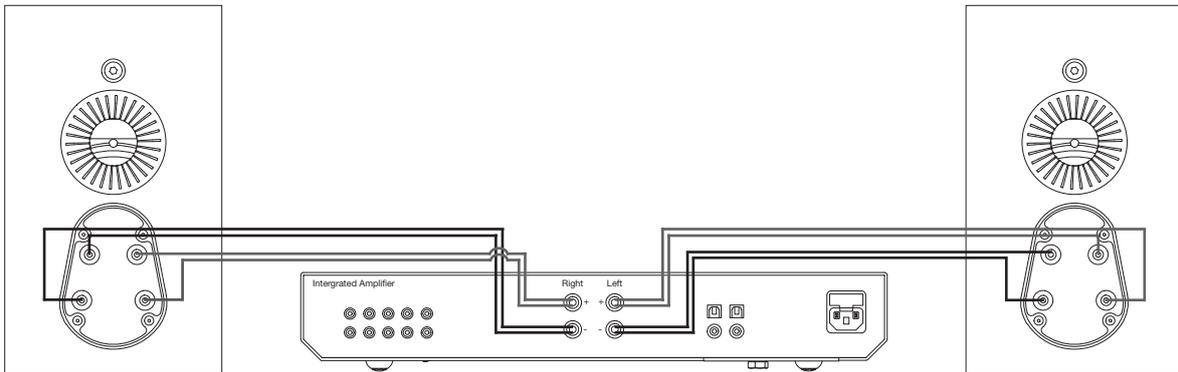
**! HINWEIS: Bei dieser Methode MÜSSEN die Klemmbrücken entfernt werden.**
