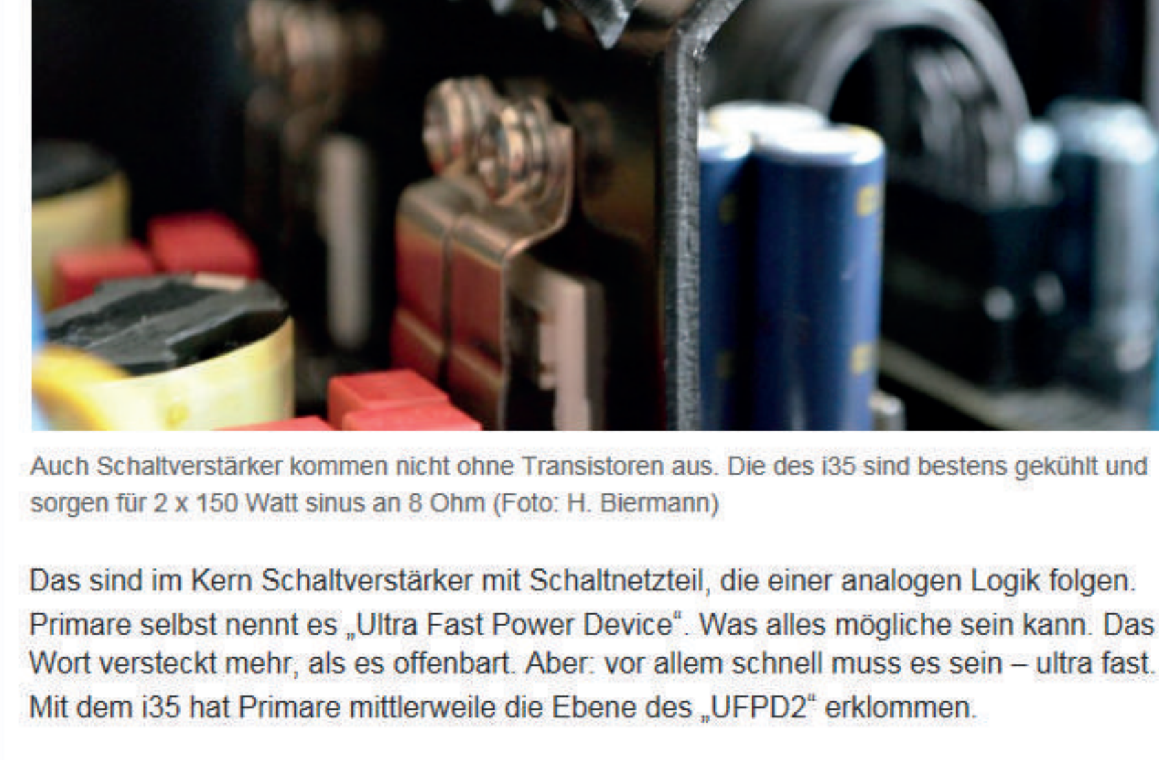
Auch Schaltverstärker kommen nicht ohne Transistoren aus. Die des i35 sind bestens gekühlt und sorgen für 2 x 150 Watt sinus an 8 Ohm (Foto: H. Biermann)
